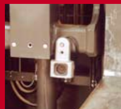
Le système FLC ( Fork Lift Camera ) est monté sur le tablier de fourches.
