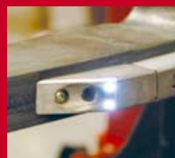
La CFMC ( Compact Fork Mounted Camera ) est fixée à l'intérieur de la fourche.
