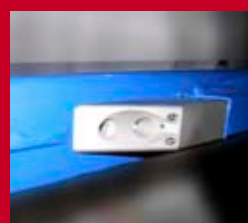
Le CFMC est un système de visibilité qui est souvent appliqué aux fourches extensibles.
